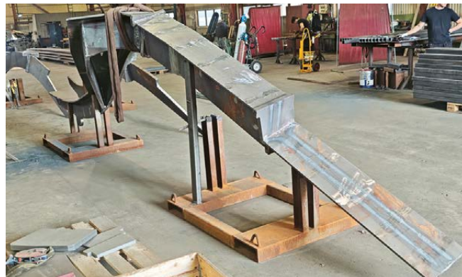
Produktion av balkarna till bron på E22 över Helg å Kristianstad,
