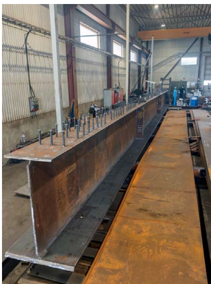
Stålbalk till den norra bron över Helge å Kristianstad.
