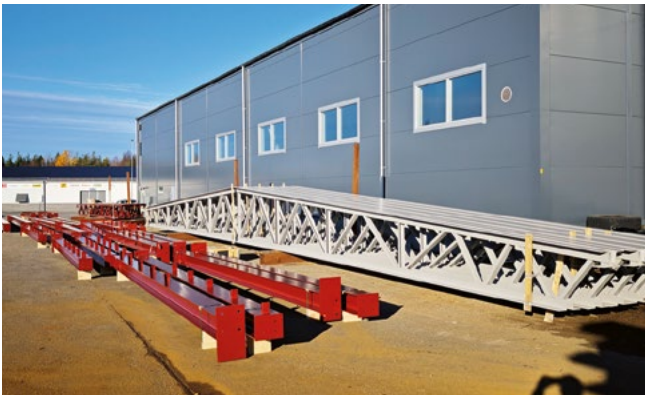
Ute på fabriksområdet står fackverk och stomstål redo för leverans.
