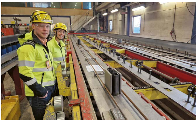
IQB balkens över- och underfläns förberedd för montagestationen.
