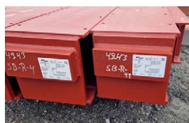
Joaquim Wallström från VSAB visar några återbrukade stål balkar som väntar på transport till Göteborg. På änden av balken visar "SB-R"-märkningen att det är en återbrukad stål balk.
