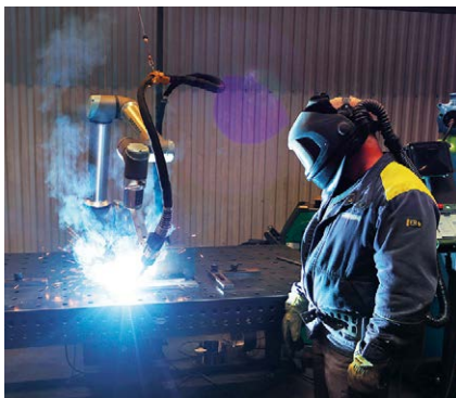
Svetsroboten är i drift under överinseende av svetsoperatören.
