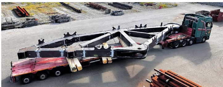
Lecor tillverkade motvikttarmar och motvikt-lådor i två delar i verkstaden i Kungälv för transport till PMK Marin i Landskrona.
