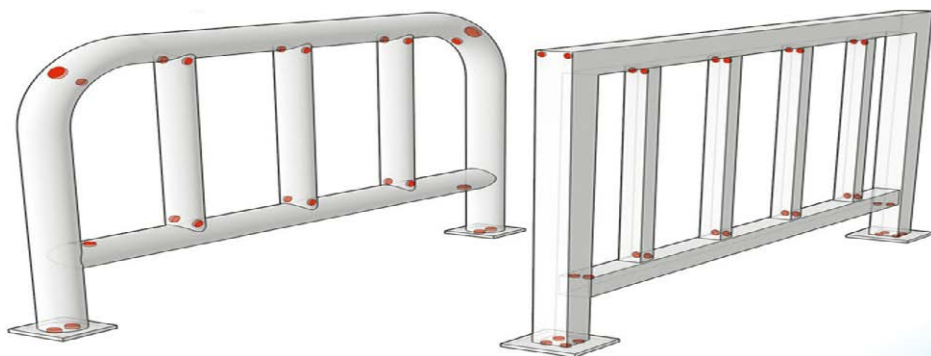
Røde punkter viser optimal plassering av dreneringshull på rekkverk laget av rør.
