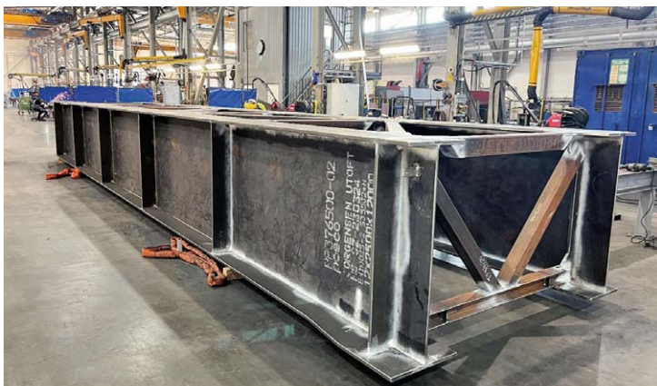
Östra tillfartsbron under tillverkning i Lecors verkstad.
