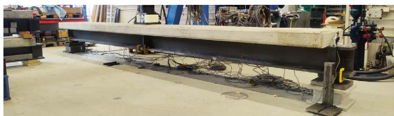
Försöksuppställning - balk i trepunktsböjning.
