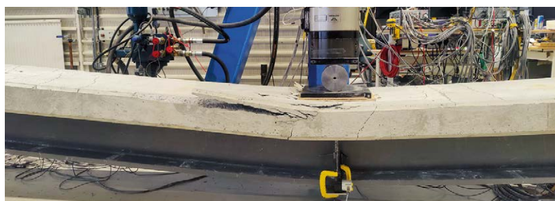
Testbalk vid brottlast. Flytning i stålet och krossbrott i betongplattans överkant.
